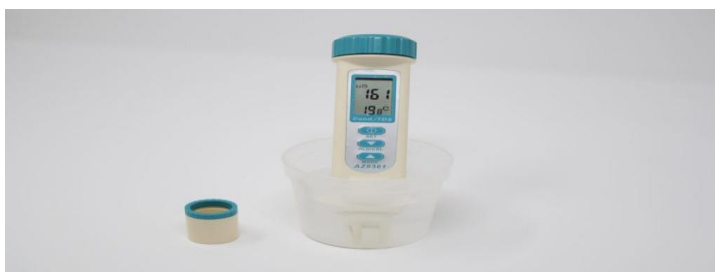
Slika 4.2. Mjerenje elektroprovodljivosti prenosivim konduktometrom (originalana fotografija Trožić-Borovac, 2022)
